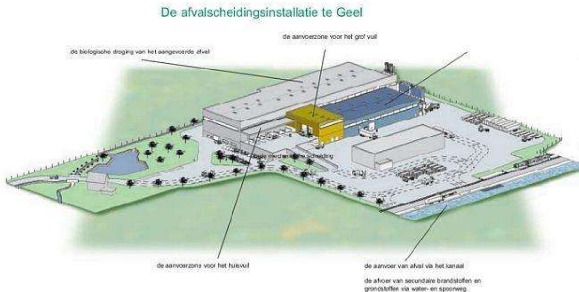
Figuur 43: Schema mechanisch-biologische scheiding IOK-IVAREM (Geel)
